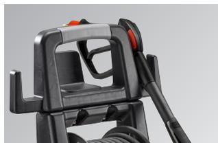
Total Stop retardé basse tension : le dispositif retarde de 15 secondes l'arrêt du nettoyeur haute pression depuis le dernier relâchement du levier du pistolet, pour des raisons de sécurité, d'économie d'énergie et de prévention des pannes ou surchauffes de la motopompe
